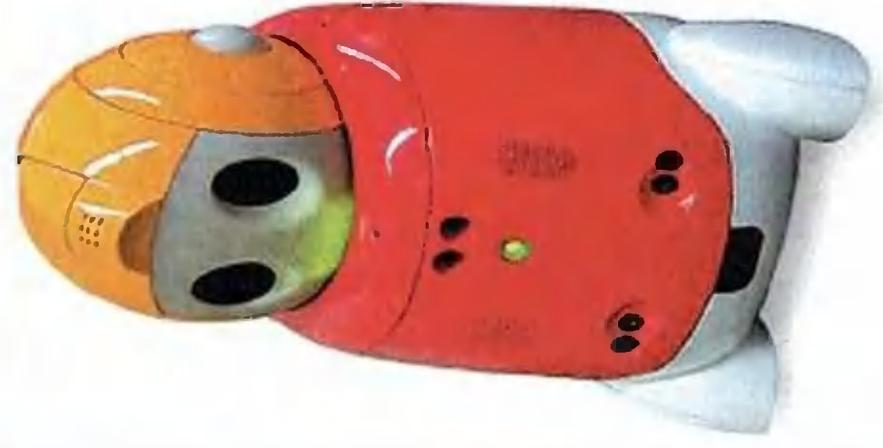
**ПРОТОТИП РОБОТА-ДЕГУСТАТОРА** построен в Японии. Он различает продукты с помощью инфракрасного спектрометра, расположенного на выдвижном манипуляторе.
