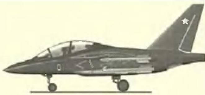
Як-130 — это двухместный двухдвигательный среднеплан с трехстоечным шасси. Его аэродинамическая компоновка, высокомеханизированное крыло с развитыми наплывами, цельноповоротный стабилизатор и расположение воздухозаборников позволяют выполнять маневры на больших углах атаки. Самолет может использовать для взлета и посадки короткие бетонные и даже грунтовые полосы.
